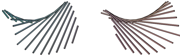
3.28: Hiperbolinio paraboloido tiesinės sudaromosios.
